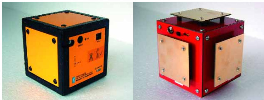
Bild 2: Potentialfreie, dreidimensionale E-Feldsonden, aufgrund ihrer Form auch als »Würfelsonden« bezeichnet; der Anschluss an die Auswerte- und Anzeigeeinheit erfolgt über eine mehrere Meter lange Glasfaserleitung, um das Feld nicht durch eine metallene Leitung zu stören – hiermit lässt sich das elektrische Feld in jeder Situation korrekt messen
