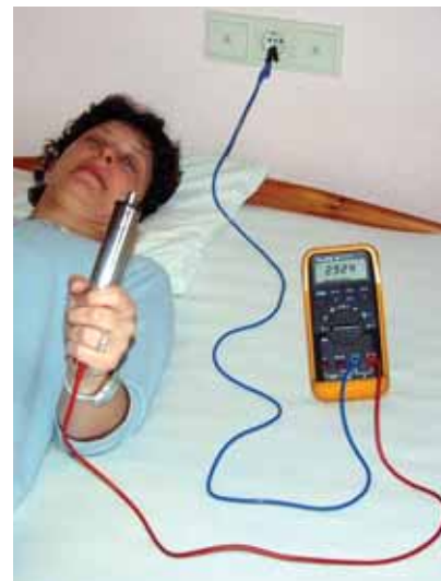
Bild 1: Körperspannungsmessung gegen Erdpotential mittels Digitalmultimeter
