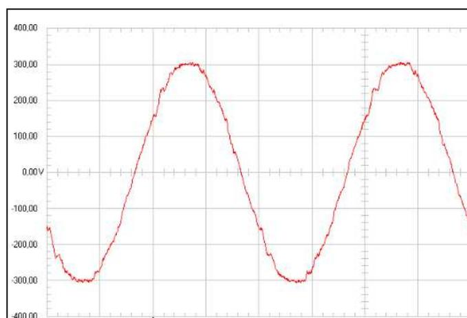
„Dirty“ Netzspannung mit offensichtlicher Störung
